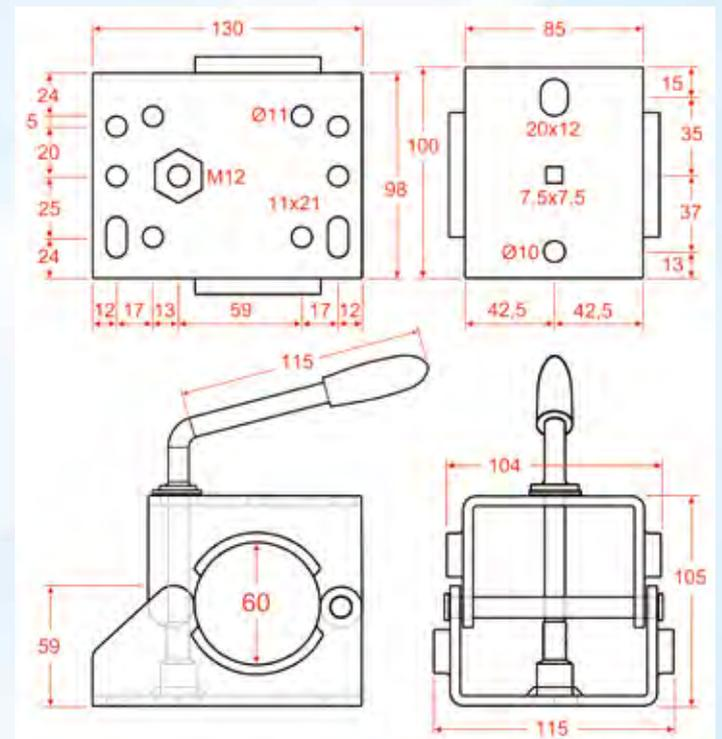
Für PKW Stützräder mit 60mm Rohrdurchmesser
