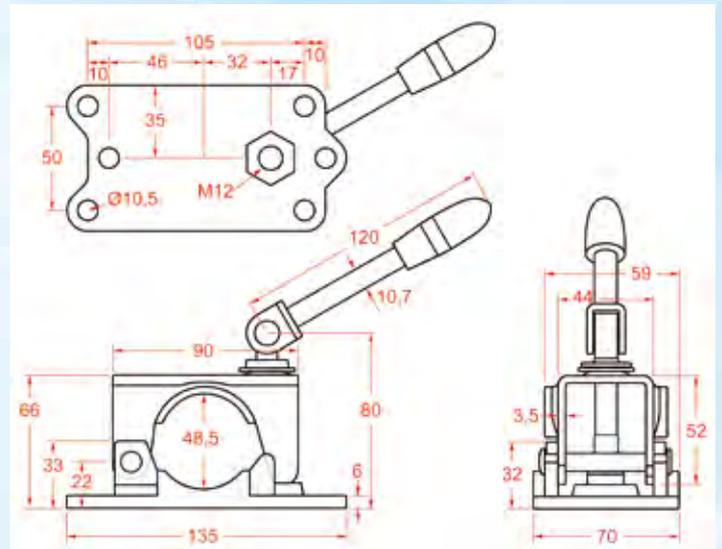
Für PKW Stützräder mit 48mm Rohrdurchmesser
