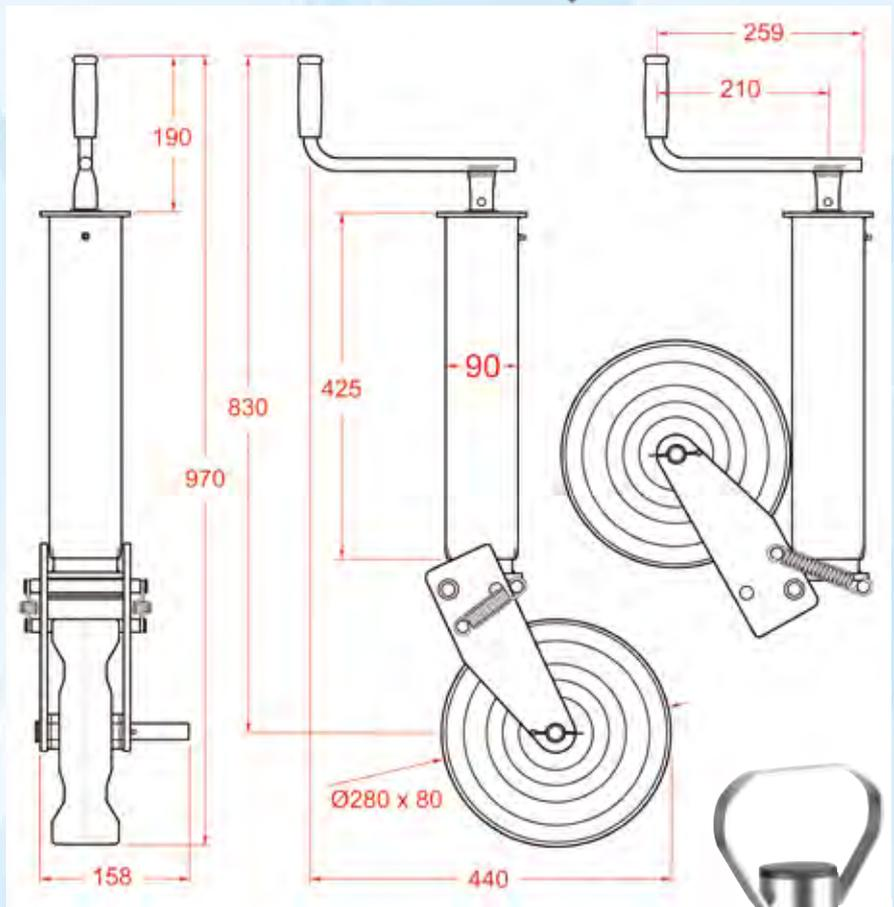
Stützrad mit Stahlrad 280x80mm mit halbautomatischem Klappvorgang und mit 90mm Rohrdurchmesser.
