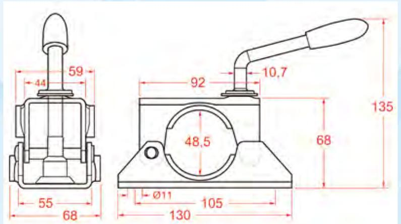
Für PKW Stützräder mit 48mm Rohrdurchmesser
