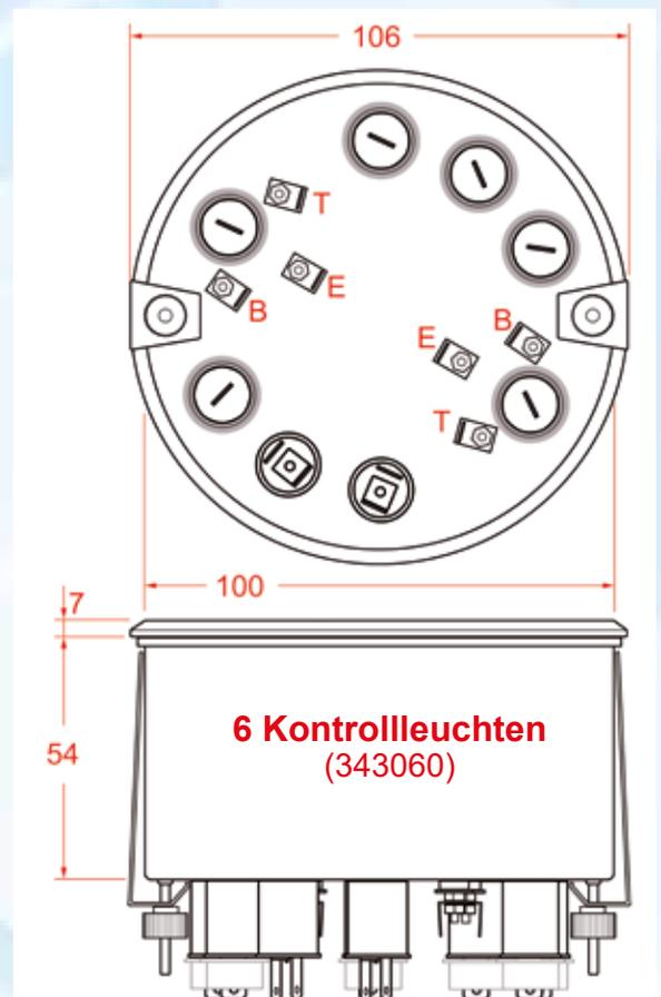
**Traktormeter für Instrumententafel**
