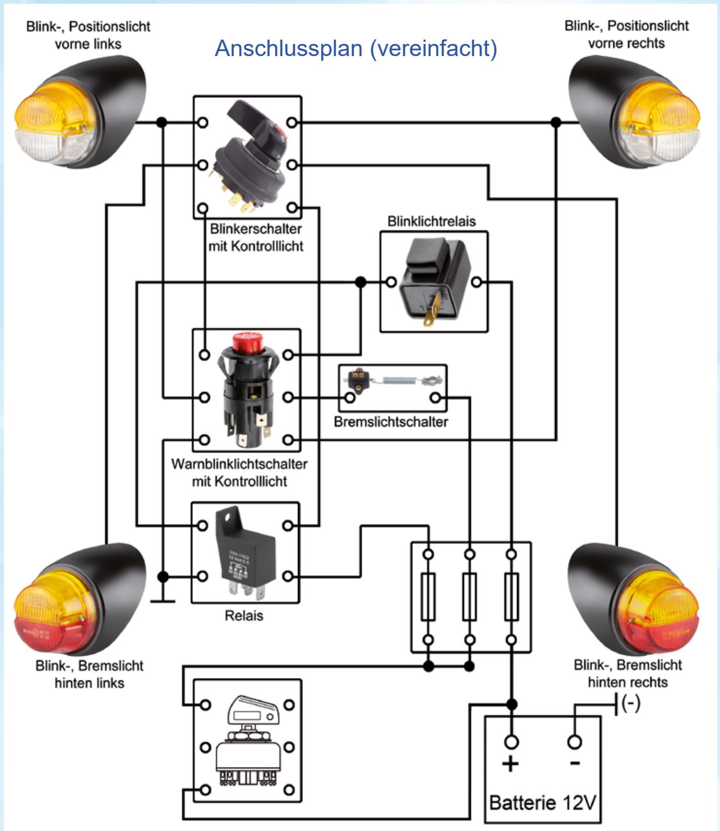
Bei der Zweikreis-Blinkerschaltung sind Brems- und Blinklicht zusammen geschaltet. Die verwendeten Rückleuchten sind Zweifunktionsleuchten mit gemeinsamer Blink-/Bremsfunktion (Gelb) und Rücklicht (Rot). Diese Schaltungsart ist überwiegend bei älteren Nutzfahrzeugen (Oldtimern) gängig.
